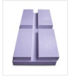
JACKODUR® Atlas ist ein Dämmsystem für Bodenplatten. Mit der intelligenten Stecktechnik erhält das Dämmsystem einen stabilen Verbund, so dass auf ein seitliches Abstützen der Bodenplatte verzichtet werden kann. Dämmen und Schalen erfolgt in einem Arbeitsschritt. JACKODUR® Atlas bietet die Möglichkeit ganz individuell mit unterschiedlichen Dämmungsdicken und Druckfestigkeiten die Bodenplatte wärmebrückenfrei zu erstellen.
